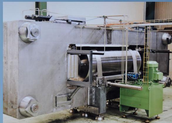
Primer prototipo de un equipo HPP
